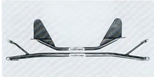
Oettinger-Federbeinabstimmung unten und vordere Querstrebe oben
