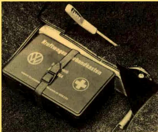
Der Verbandkasten wird unterhalb des Beifahrersitzes eingebaut und durch ein Halteband am "Querträger für Bodenblech" befestigt.
